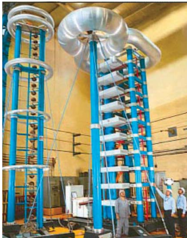
Генератор импульсных напряжений – 2 000 кВ (пиковое знач.)
