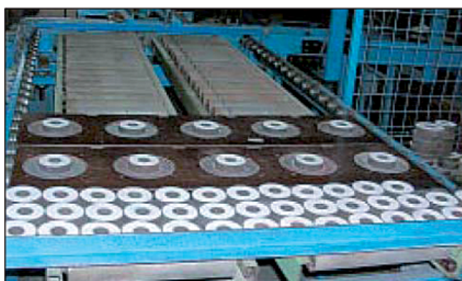
Рис.3 Различные типы варисторных (ZnO) элементов
