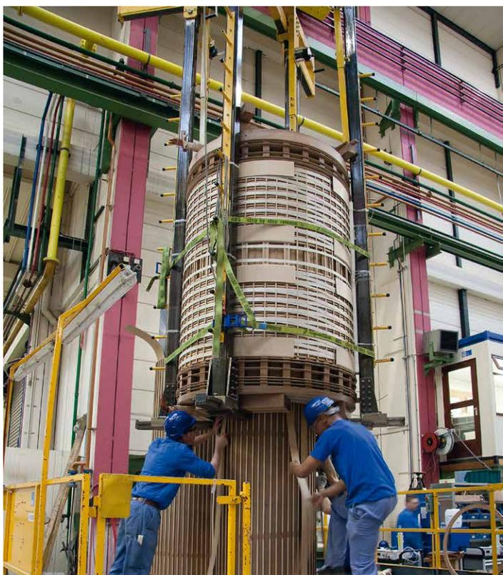
Сборка катушки тягового трансформатора 60 МВА
