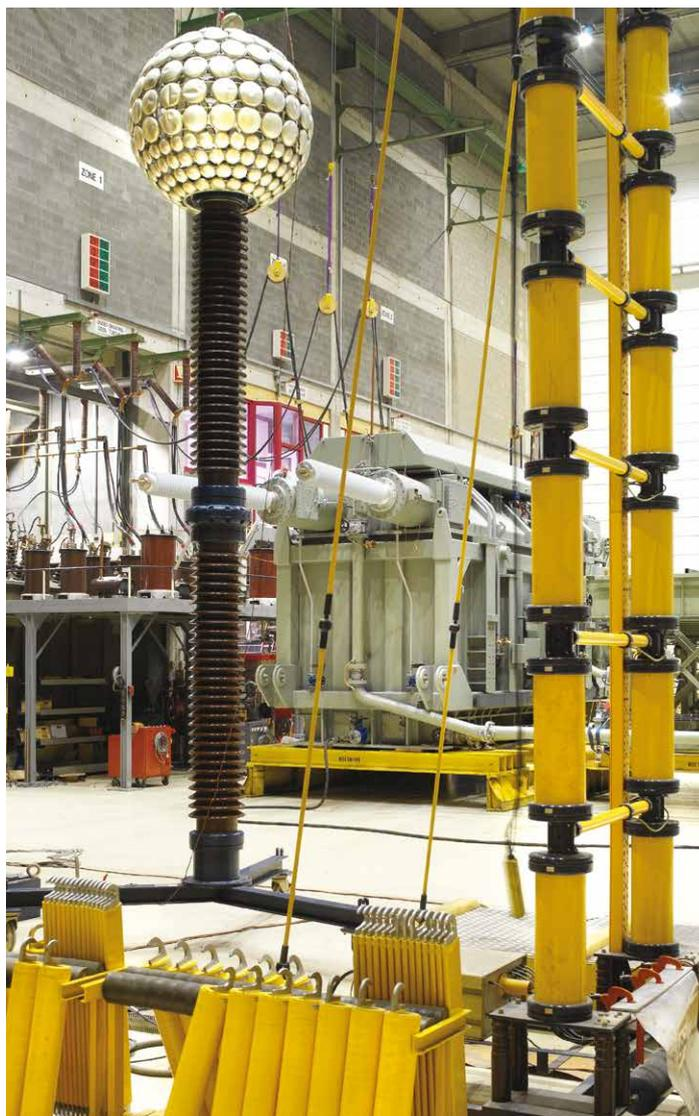
Подготовка к испытаниям генераторного трансформатора 150 МВА 235/34,5 кВ с системой принудительно-масляного и принудительно-воздушного охлаждения ODAF в соответствии со стандартами Немецких Железных Дорог.
