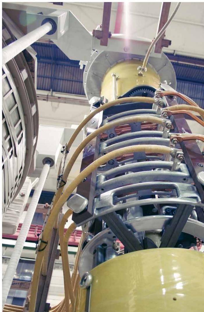
Вид снизу смонтированного РПН, тип Reinhausen M III 500 Y 72,5/B 10193W
