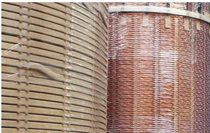
Готовые обмотки ожидают последующего монтажа
