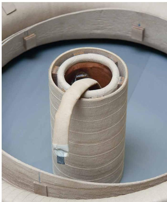
Для оптимизации конструкции с точки зрения распределения электрического поля применяются специально отформованные изоляционные компоненты
