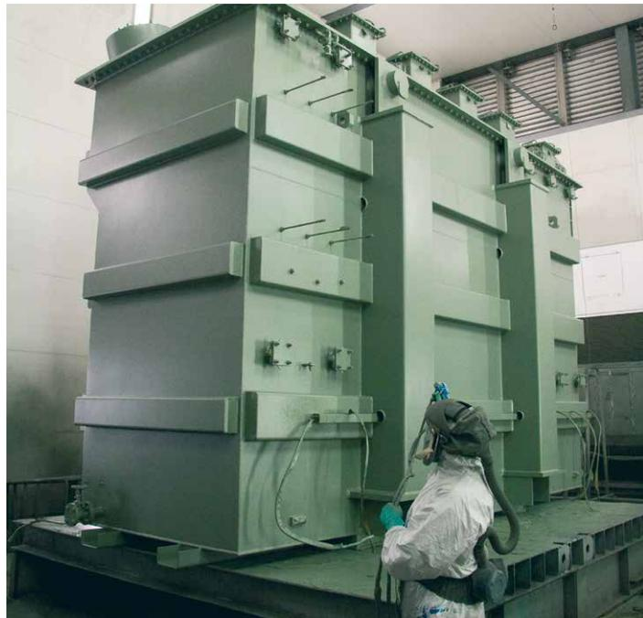
Перед транспортировкой поверхность баков обрабатывается воздушной струей.
