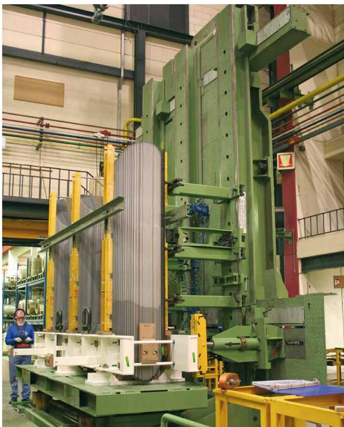
Монтаж магнитопровода после шихтовки
