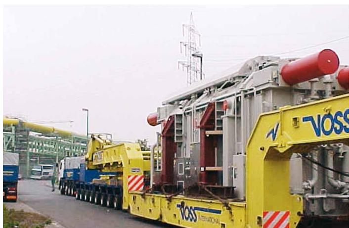
Транспортировка повышающего генератор-трансформатора 332 МВА (с водяным охлаждением); 115/21 кВ для немецкой энергетической компании RWE
