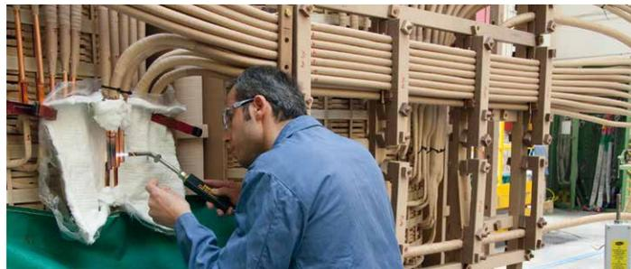
Пайка выводов обмотки 40 МВА 230 кВ
