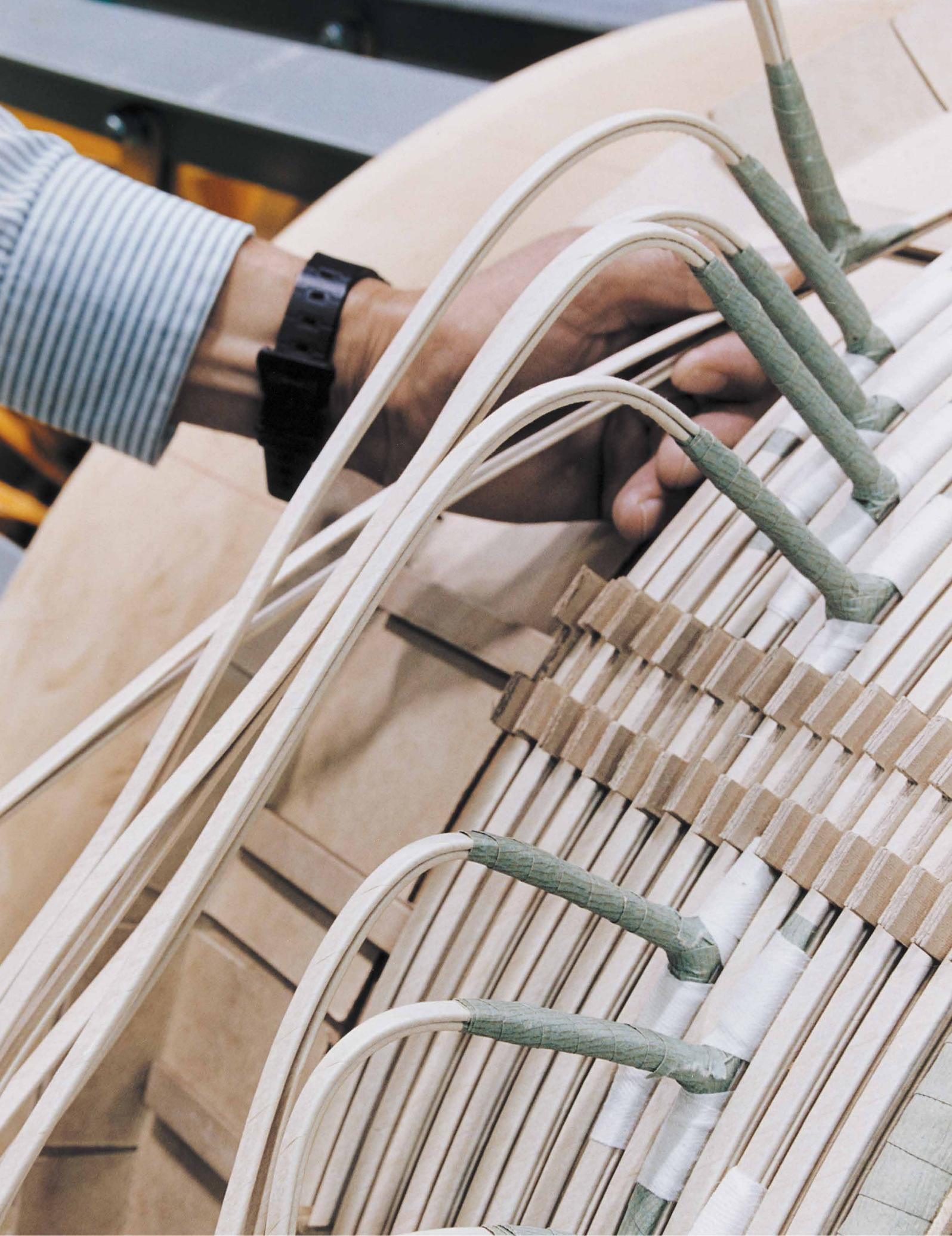
Изготовление регулировочных ответвлений из двухжильного медного провода
