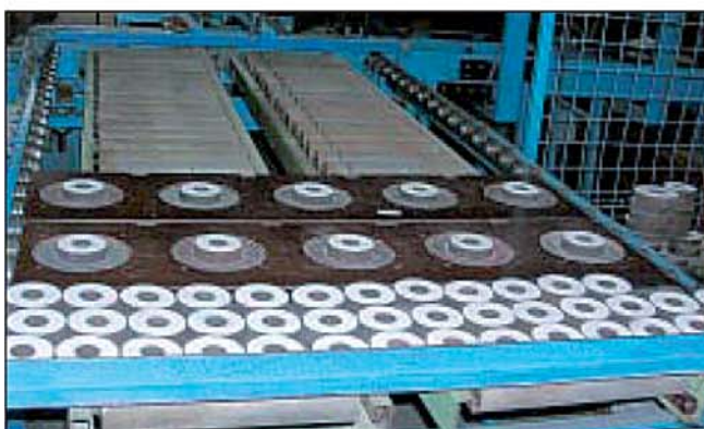
Рис.3 Различные типы варисторных (ZnO) элементов
