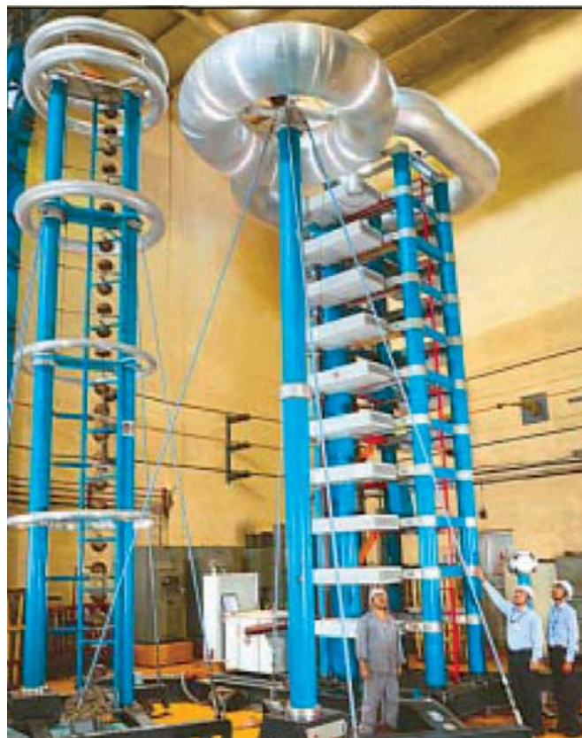
Генератор импульсных напряжений – 2 000 кВ (пиковое знач.)
