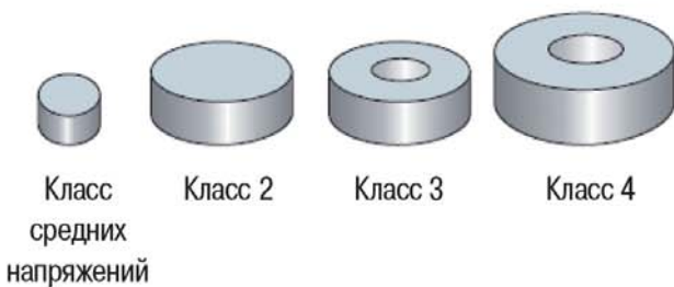
Рис.3 Различные типы варисторных (ZnO) элементов
